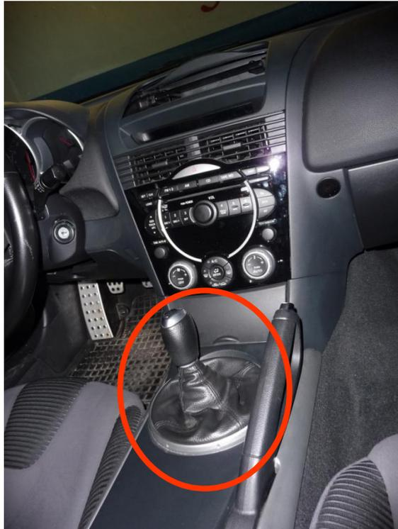
2. Nun die beiden Schrauben beim Aschenbecher entfernen und diesen herausziehen.
