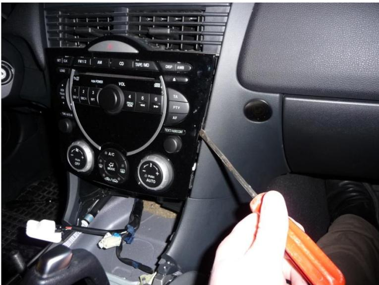
Wenn die HU zum ersten Mal herausgenommen wird, kann man diese nur ca. 1cm herausziehen. Das kommt daher, dass Mazda bei der Montage die Kabel hinter der HU fixiert hat. Um dieses zu beheben, ist es notwendig, das Handschuhfach zu entnehmen um dann mit viel Fingerspitzengefühl (und wer sich traut mit dem Skalpell) die Klebebänder um die Kabel herum zu entfernen. Erst danach sind die Kabel so flexibel, dass sich die HU herausziehen lässt.
