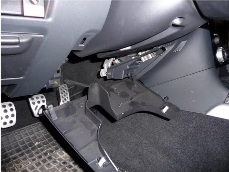
6. Die Schraube der Seitenhalterung der HU mit der 10er Nuss entfernen.
